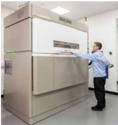
**Il modello Ricoh AM S5500P ha un volume di costruzione di 550x550x500 mm.**
